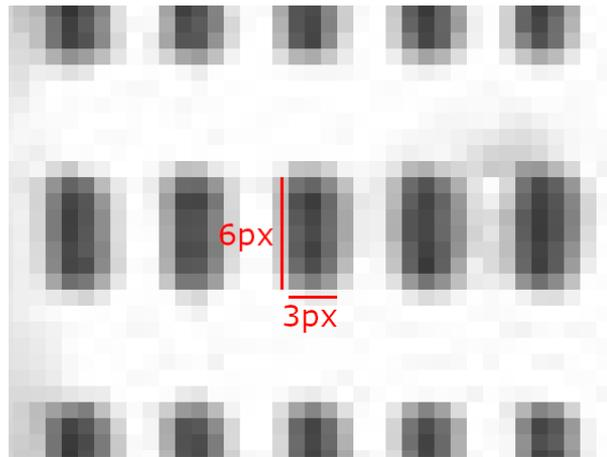
**Abbildung 2.5:** Pixelmessung bei 10-facher Vergrößerung
