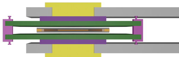
Abbildung 8: Vereinfachte Ansicht der Bestandteile der Musterhalterung von oben. Die beiden Magnetmuster sind in Musterfassungen (dunkelgrün) eingegossen. Diese sind je über eine Zwischenplatte (violett) an einer Drehscheibe (gelb) befestigt, welche sich innerhalb einer Einkerbung in den Haltearmen (grau) drehen kann. Zwischen den beiden Musterplatten befindet sich ein Tank (orange), in welchen Stahlkugeln und Tracking-Objekte eingebracht werden können. Abstandhalter (rosa) sorgen dafür, dass die Musterfassungen parallel sind.
