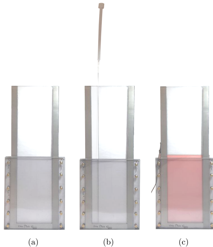
Abbildung 18: Verschiedene Ansichten des verwendeten Wassertanks mit Verstärkerplatten im unteren Bereich. Die beiden großen, durchsichtigen Seitenwände des Tanks bestehen aus Makrolonplatten, welche mit Epoxid-Harz auf flache Aluminiumstreben geklebt sind. Diese bilden so die anderen beiden Seiten und den Boden des Tanks. (a) Der Wassertank mit Verstärkerplatten. Da die Makrolonwände sehr dünn sind, müssen sie verstärkt werden, damit der Tank unter der Last des eingefüllten Wassers nicht nachgibt und zerbricht. Dafür sind zwei starke Makrolonplatten auf beiden Seiten des Tanks unterhalb des Bereichs, in welchem sich im Experiment die Musterfassungen befinden, aneinander geschraubt. Abstandhalter um die Schraublöcher verhindern, dass die Verstärkerplatten sich aufgrund der Schrauben zu sehr biegen. (b) Zum Befüllen des Wassertanks eignet sich ein dünnes Metallrohr wie das hier gezeigte mit einem Durchmesser von 1,5 mm. Es wird senkrecht in den Tank geschoben, bis es den Boden erreicht hat. Dann kann mithilfe eines Trichters am oberen Ende des Rohrs der Tank ohne Bläschenbildung von unten her aufgefüllt werden. (c) Hinter den Verstärkerplatten wird eine Leuchtfolie angebracht. Diese ist im ausgeschalteten Zustand rosa, angeschaltet leuchtet sie weiß und kann Kameraaufnahmen verbessern.
