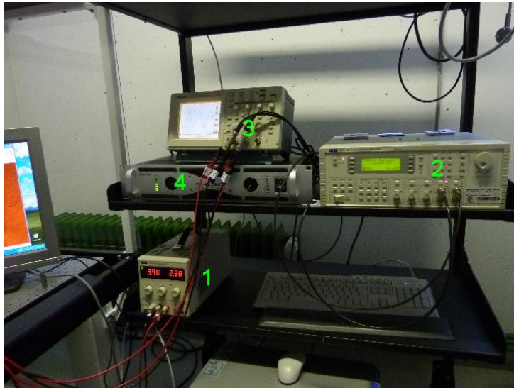
Abbildung 3.3: Gleich- und Wechselstromgenerator (1 und 2), sowie ein digitales 2-Kanal-Oszilloskop (3) und ein Verstärker (4) zur Erzeugung des Blasengitters auf dem Granatfilm
