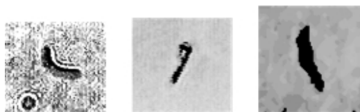
Abbildung 6.1: 3 Beispiele für Nickelnanodrähte mit unregelmäßiger Form. Während des Herstellungsprozesses kommt es zur Ausbildung von unregelmäßig geformten Nickelnanodrähten, deren Form die Messgenauigkeit negativ beeinflusst.
